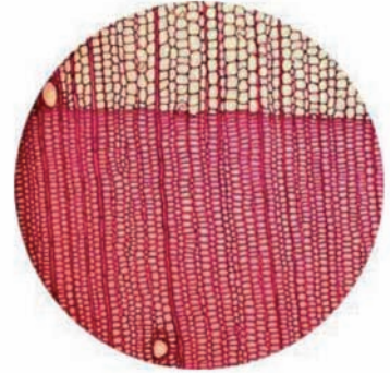
Corte transversal microscopico, aumento 10x (Fuente UBB)
