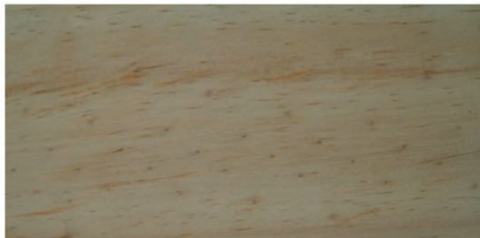
Corte radial macroscópico (Fuente UBB)
